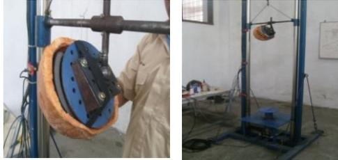
Gambar 3.1. Pemasangan helmet sepeda pada *tes rig*
